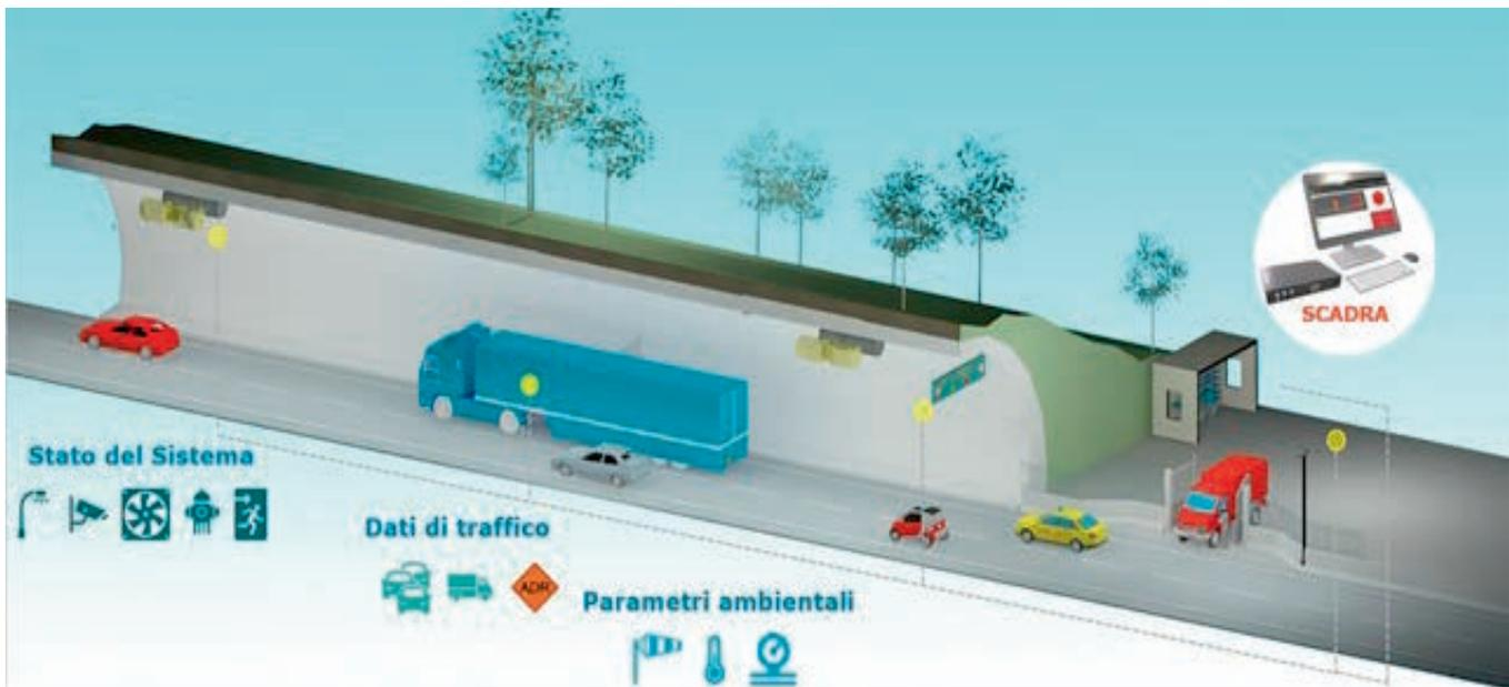
Figura 2: Tunnel monitorato con SCADRA
