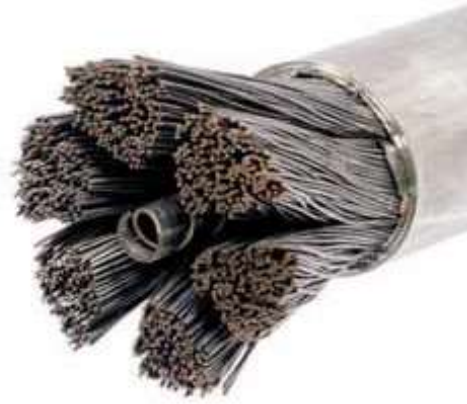
Figura 4 Uno dei cavi usati per creare il campo magnetico toroidale di ITER
