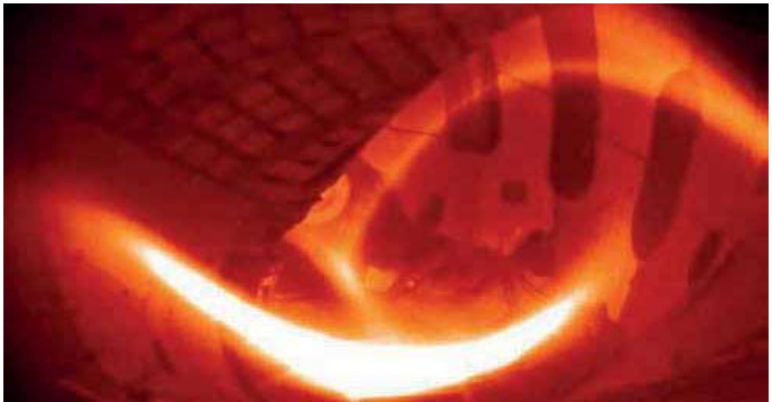
Figura 1 Il primo plasma ottenuto al reattore di Wendelstein 7-X. Le temperature hanno raggiunto i 100 milioni di gradi Celsius.
