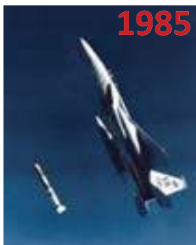
USAF F15- ASM135 ASAT Boeing - I° Stadio Vought - II° Stadio e Guida Lungh: 5,4 m Peso: 1179 kg Altiudine Max: 560 Km
