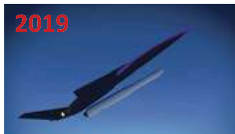
Aevum - Space Delivery Services Sistema di lancio RAVN : RPAS + Missile I° Stadio: RPAS – Velocità max: Mach 2.85 II° Stadio - Propellente "Proprietario" III° Stadio - Ossigeno Liquido
