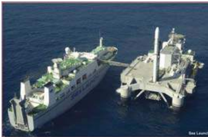
Elementi chiave del sistema di lancio SEA LAUNCH: piattaforma di lancio e nave di trasporto, appoggio e controllo.
