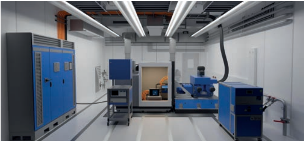
Figura 33: Rendering di una camera di test per motori elettrici
