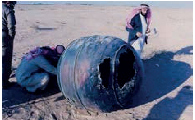
Figura 17 Serbatoio di satellite rientrato in atmosfera e caduto al suolo
