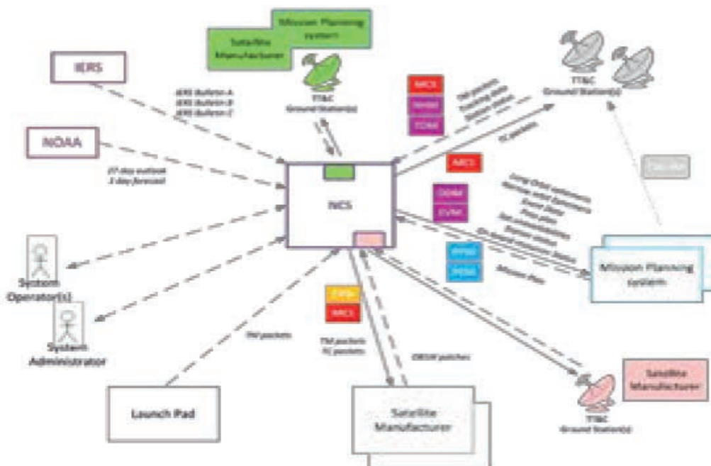
Figura 21 Schema del sistema di gestione satelliti NCS
