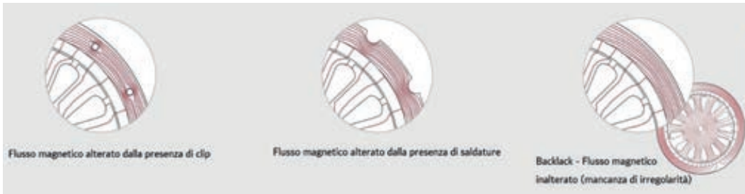
Fig. 22: Confronto del flusso magnetico tra fasci di acciaio elettrico uniti meccanicamente e quelli con Backlax
