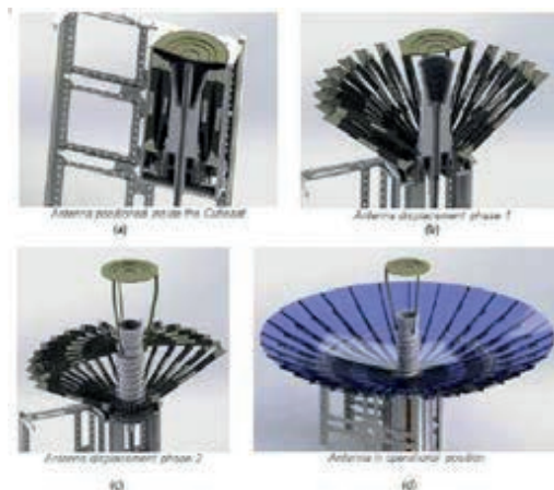
Figura 12 - Antenna deployable in banda Ka per ISL LEO-GEO
