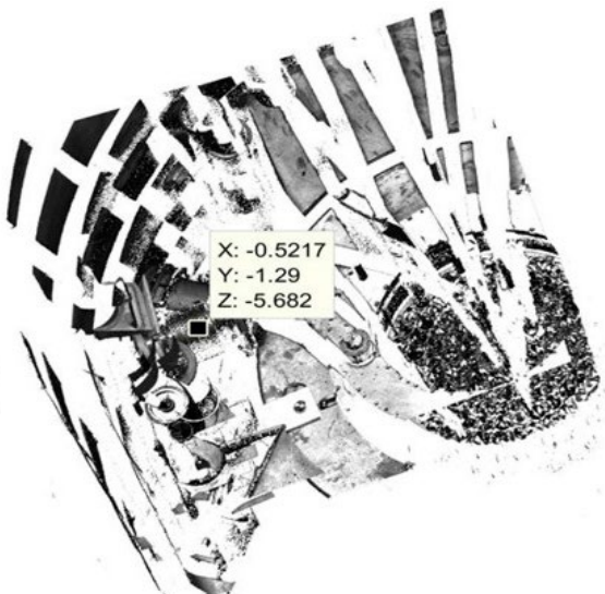
Figura 3 "Modello 3D delle barre acquisito all'interno della piscina del reattore"
