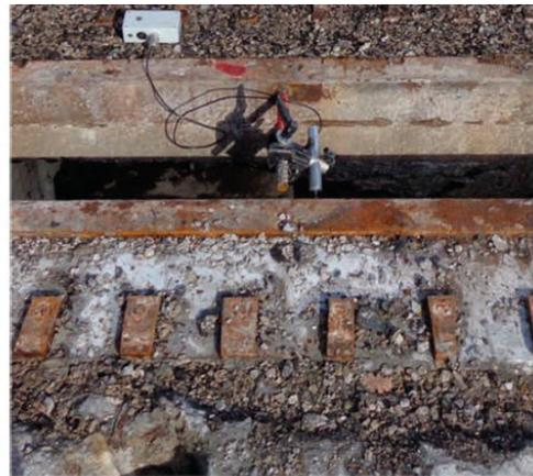
**Controllo degli spostamenti longitudinali con trasduttori di spostamento wireless (CMS S.r.l.)**
