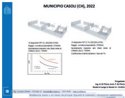
Figura 19 - isolamento sismico struttura esistente
