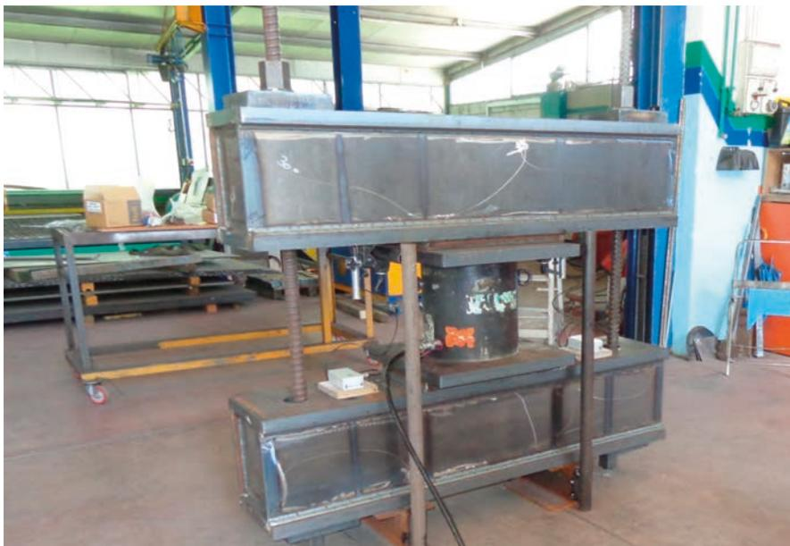
Figura 19 - Prova di collaudo delle traverse di precompressione (CMS S.r.l.)
