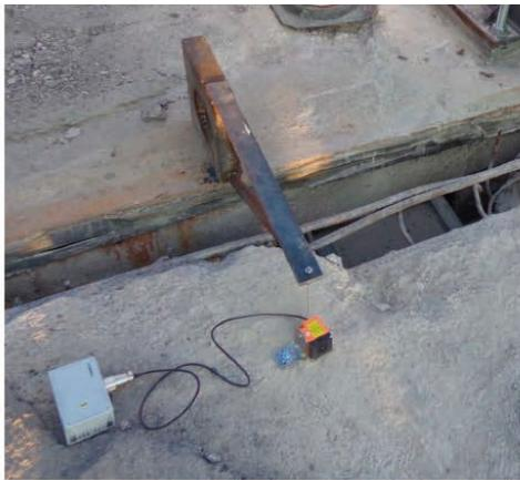
**Controllo degli spostamenti verticali con encoder wireless (CMS S.r.l.)**
