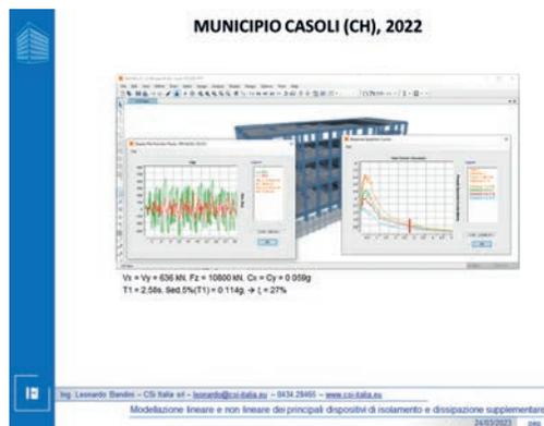
Figura 21 - isolamento sismico struttura esistente
