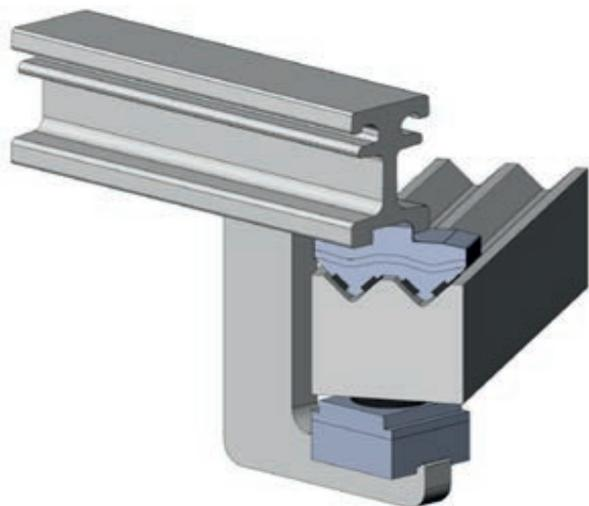
Uno svantaggio dei giunti modulari è rappresentato dalla loro considerevole altezza, che va tenuta in conto qualora si volessero installare in opere esistenti, dove non sempre è possibile avere lo spazio sufficiente.
