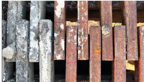
Figura 7 – Degradamento degli apparecchi di giunto
