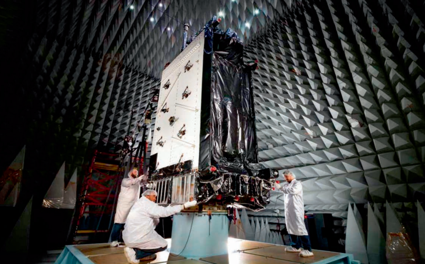
Figura 8 - Prove di compatibilità elettromagnetica.
