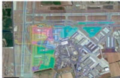
Negli ultimi anni sull'Aeroporto di Fiumicino sono state messe in esercizio n. 62 nuove piazzole di sosta per automobili di diversa capacità (Code C, Code E, Code F), sia di tipo a contatto che di tipo remoto.
