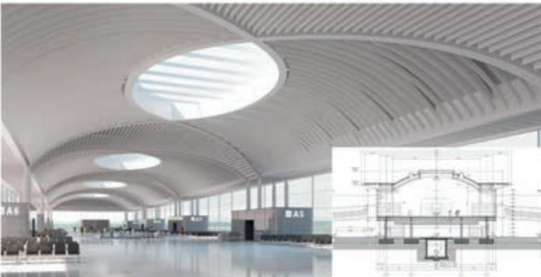
La soluzione prevede una struttura di copertura con un sistema a travi piane ad archi ipocotati. Le officine interne variano da 7,50m a 11,50m
