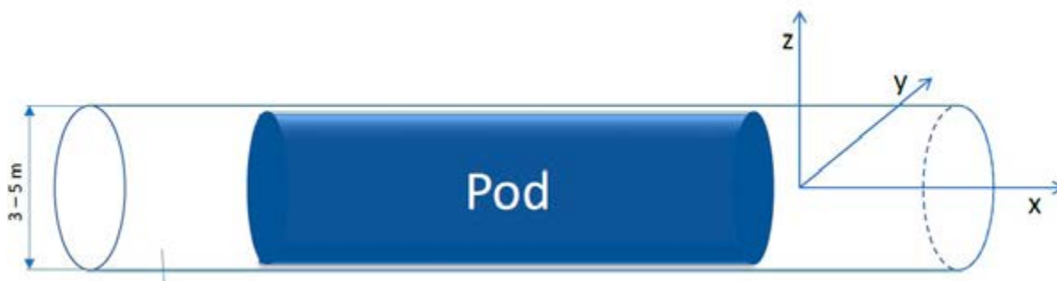
Figura 1 - Principio di funzionamento di Hyperloop: un contenitore di trasporto "pod" si muove in un tubo quasi sottovuoto (100 Pa)
