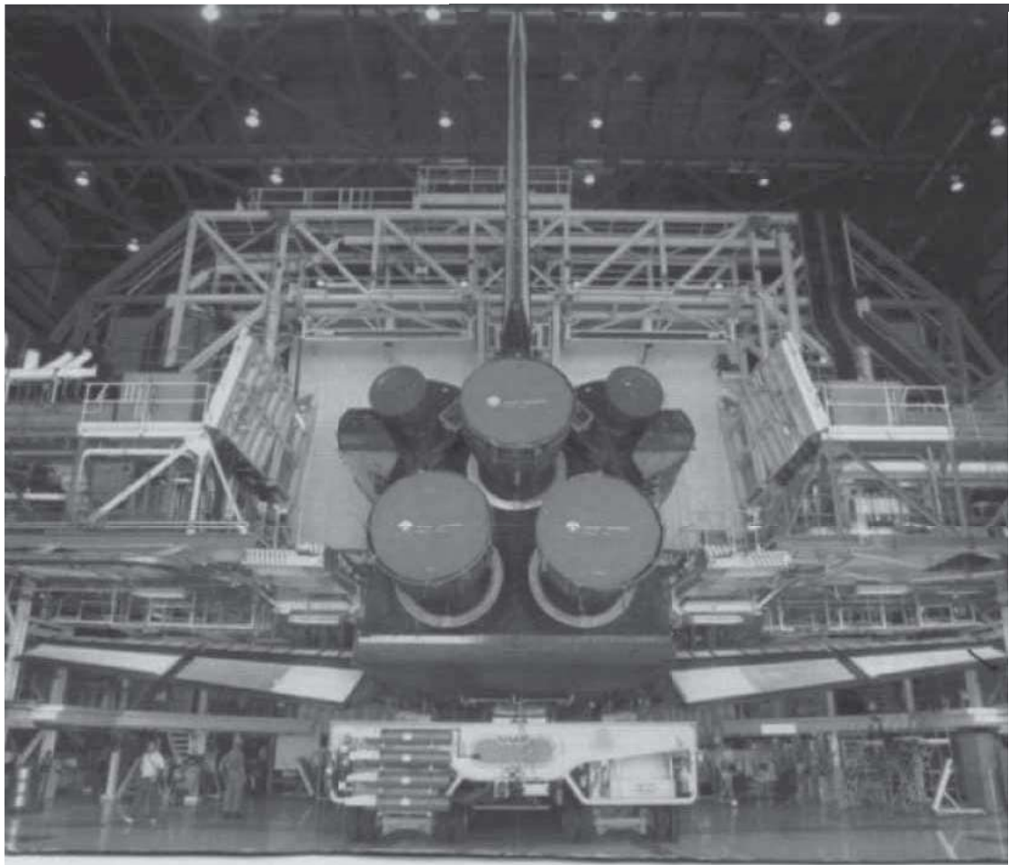
Figura 11: Motori principali del Discovery
