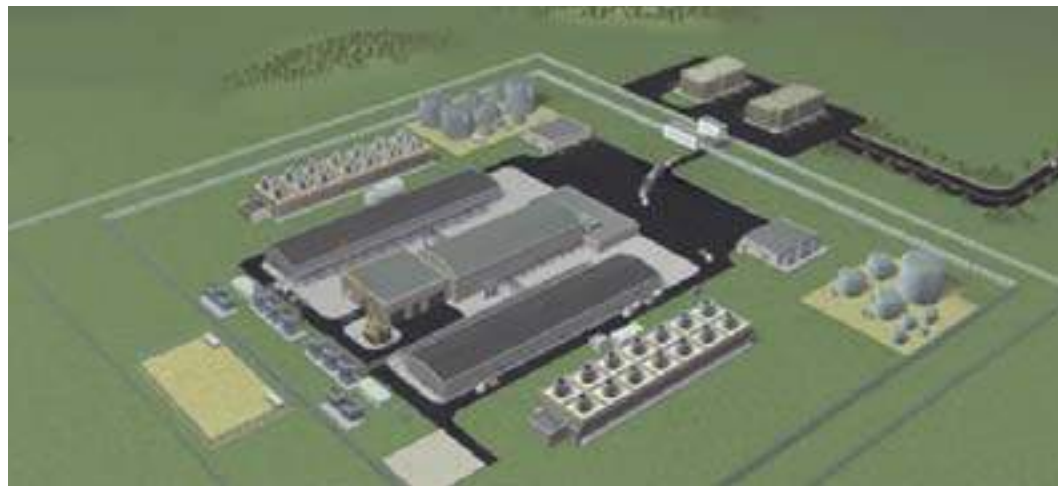
Figura 1 - reattore Nuscale Lay – out e schema d’impianto a 12 unità (540 MWe)
