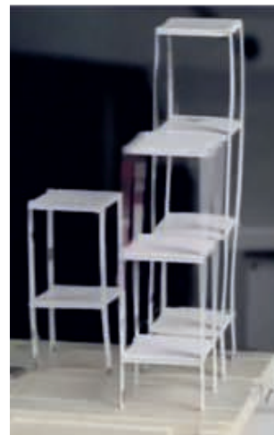
Figura 12 a frequenza intermedia la struttura intermedia inizia a oscillare in modo evidente
