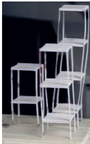
Figura 11 a bassa frequenza la struttura più alta oscilla, le altre sono fisse
