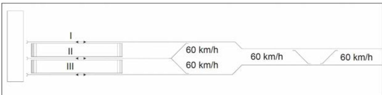
Figura 4 - Layout funzionale della stazione ferroviaria di Fiumicino Aeroporto
