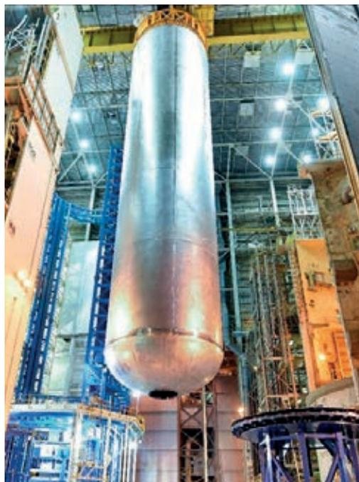
Figura 12 - Serbatoio di Idrogeno liquido del SLS. Fonte: [www.eoportal.org](http://www.eoportal.org).
