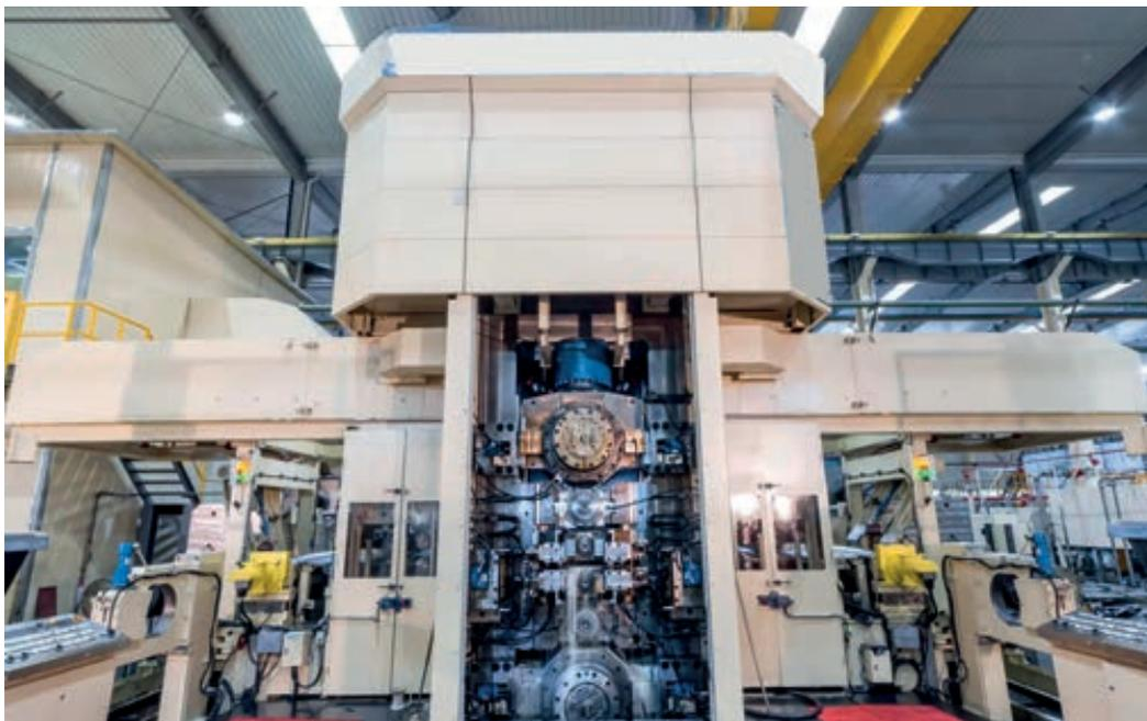
Figura 16 - vista laterale di un laminatoio sesto
