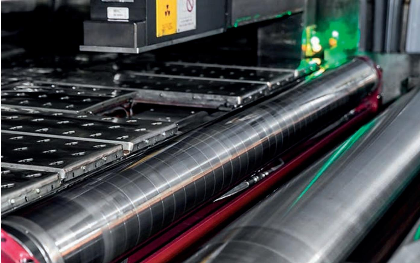
Figura 20 - misuratore di spessore e rullo stressometrico
