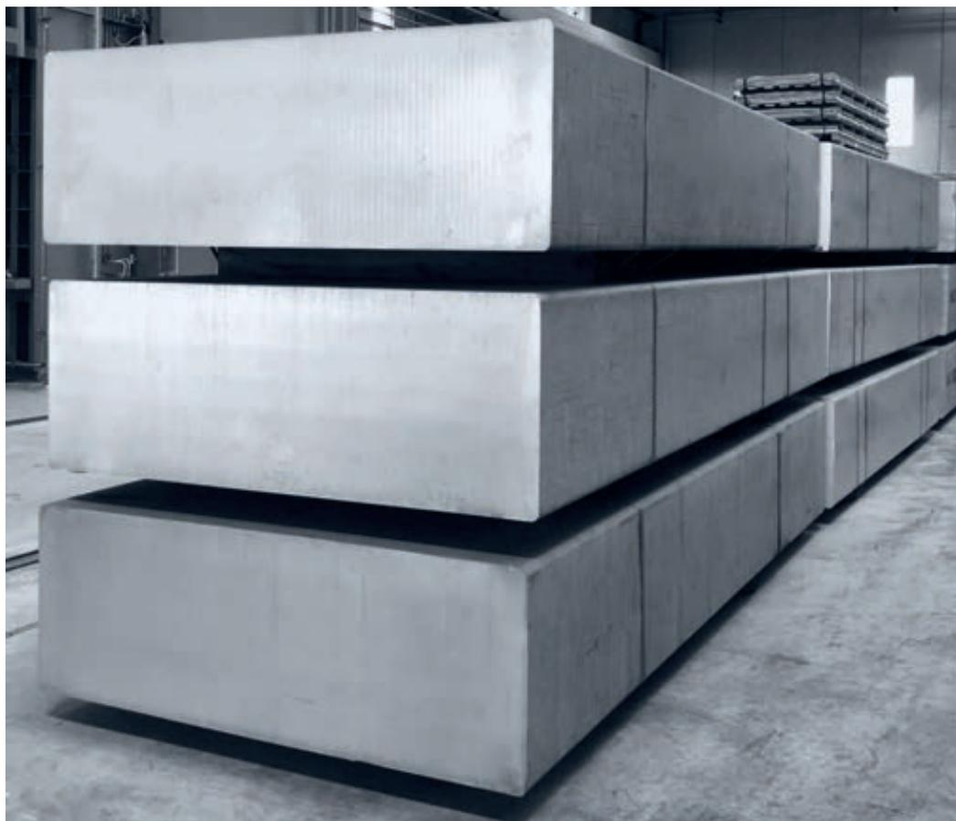
Figura 3 - Bramme di alluminio per il processo di laminazione a caldo
