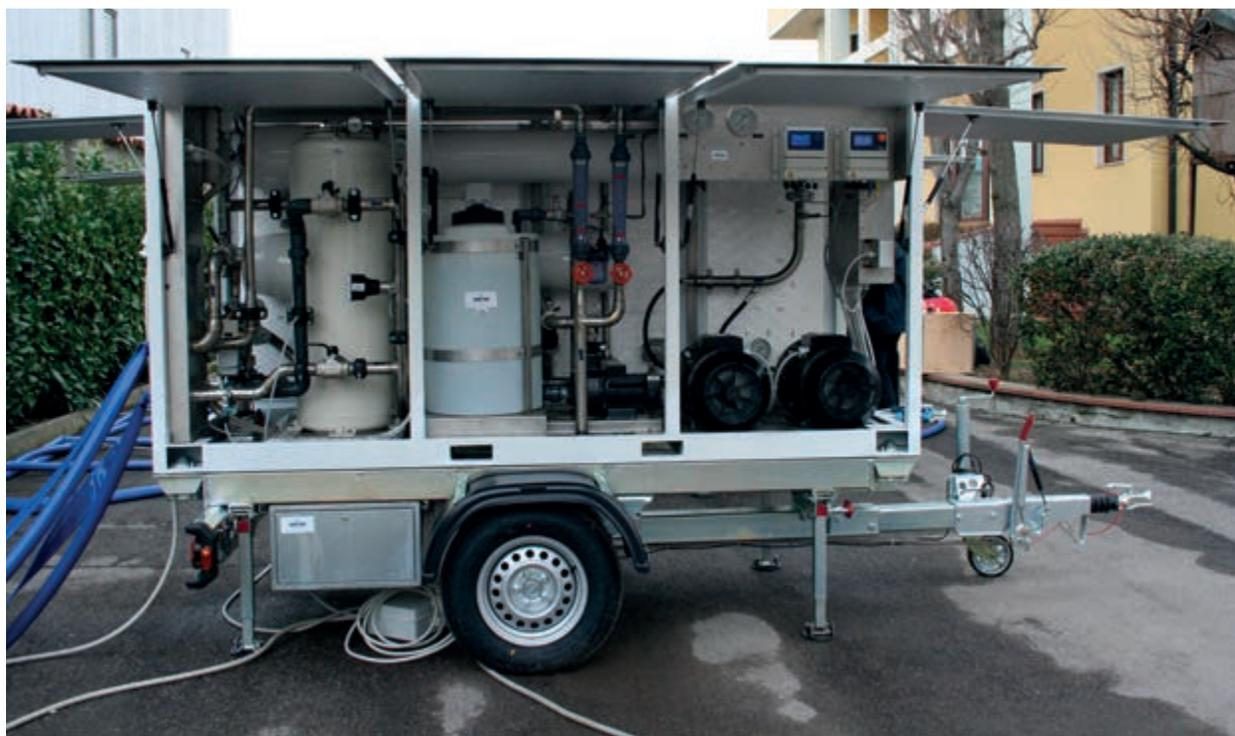
Figura 1 - Impianto mobile per Campi Profughi delle Nazioni Unit.
