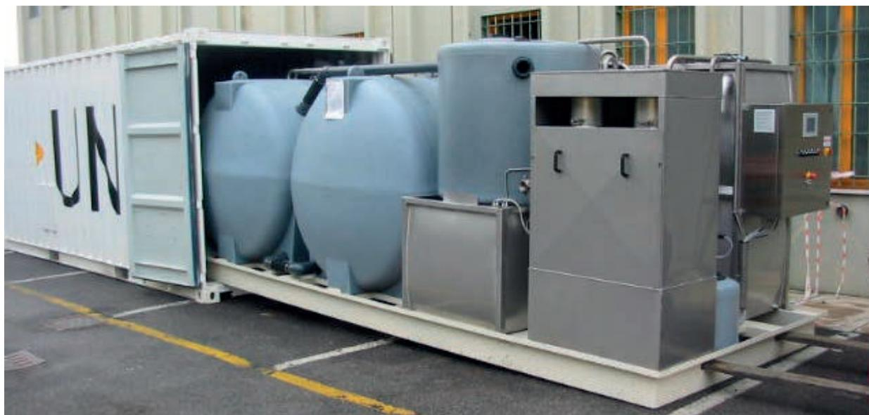
Figura 6 - Gli impianti sono costruiti e testati in stabilimento, poi inseriti in Container e spediti. Una volta a destinazione basta collegarli ad una fonte d'acqua da depurare ed all'energia.
