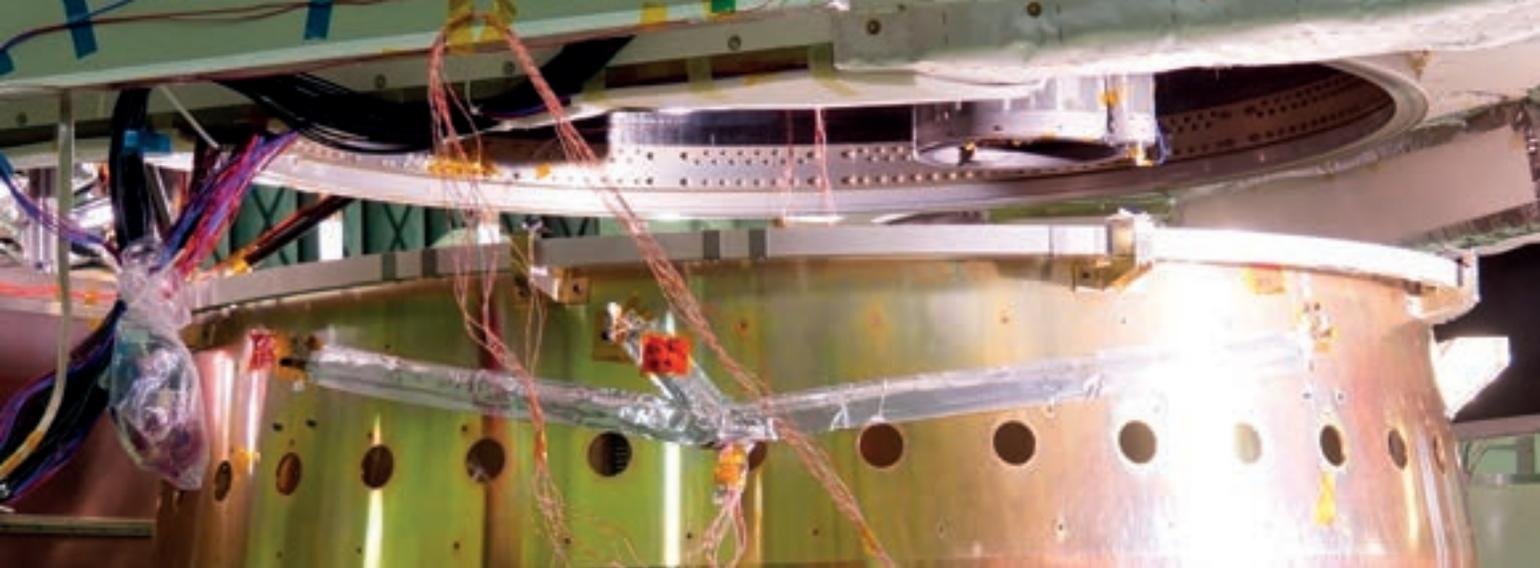
Figura 8 - Clampaggio Marman con separazione comandata per applicazioni spaziali (<http://sci.esa.int/>)
