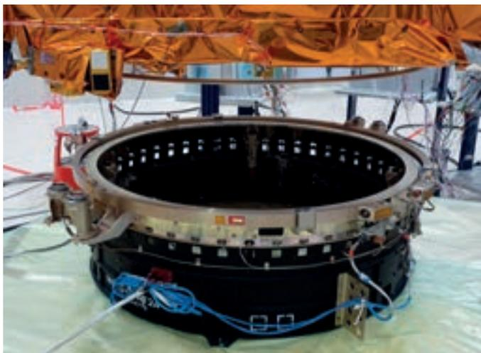
Figura 6 - Clampaggio con separazione comandata in applicazioni spaziali (<http://www.eurockot.com>)
