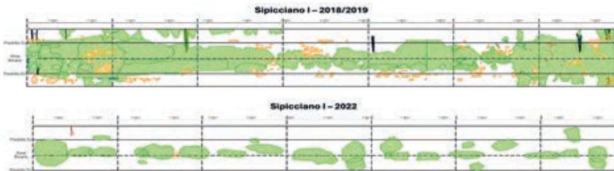
Figura 6 – Analisi difettologica effettuata prima e dopo l'intervento: riduzione delle aree interessate da infiltrazioni di acqua.
