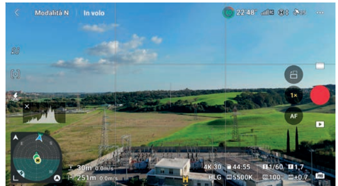
Figura 4 - utilizzo della telemetria per fermare il volo alla distanza di 250 m
