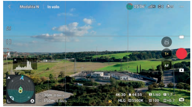
Figura 2 - utilizzo della telemetria per fermare il volo alla ALOS calcolata di 150 m
